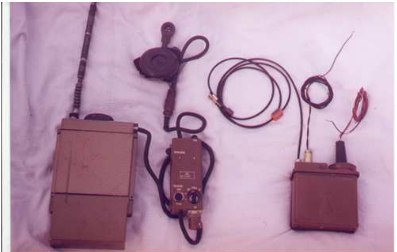
Рис.1 Радиолиния ПД-430, подготовленная для работы совместно с радиостанцией Р-392 и МИП.
