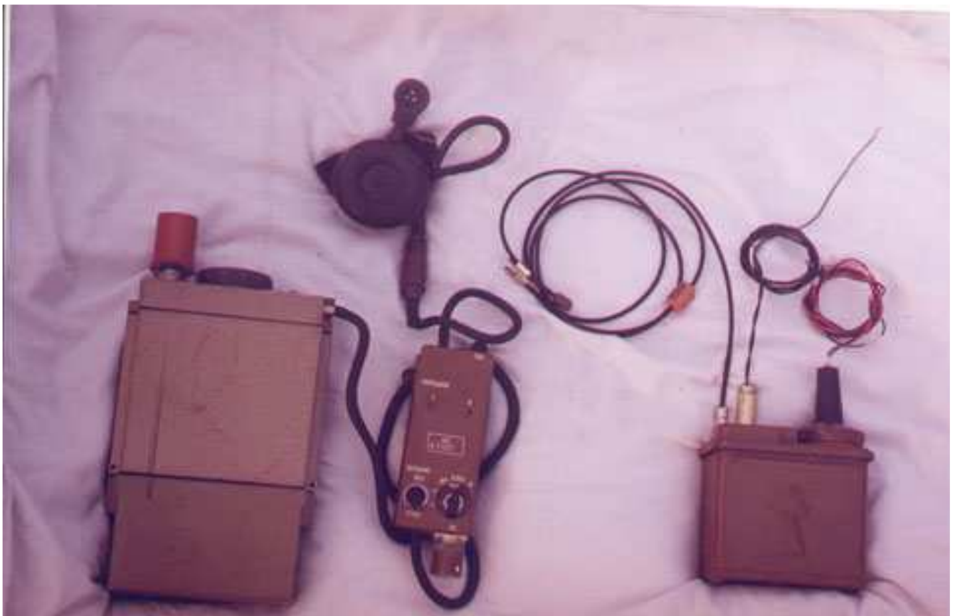
Рис.2 Радиолиния ПД-430, подготовленная для проверки на эквивалент антенны совместно с радиостанцией Р-392 и МИП.
