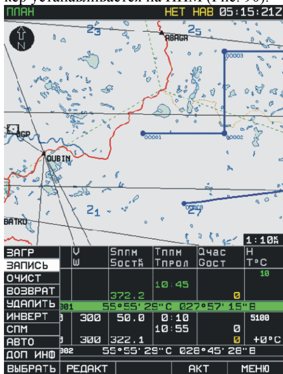
Рис. 87. Выбор функции сохранения плана полета
