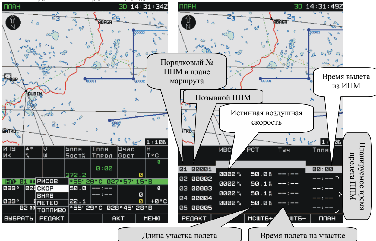
Рис. 62. Выбор подменю для ввода истинной воздушной скорости
