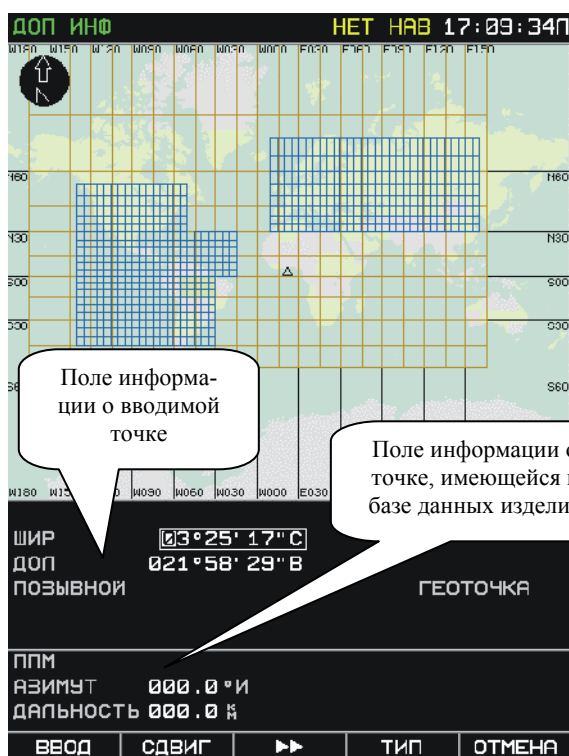
Рис. 138. Ввод навигационной точки по известному азимуту и расстоянию
