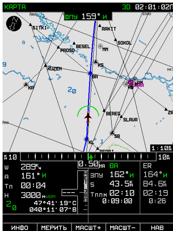
Рис. 17. Вид дисплея в подрежиме КАРТА
