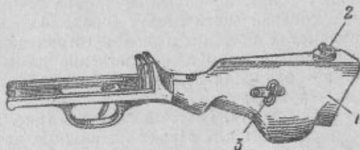
Рис. 20. Спусковая рама с прикладом: 1 — приклад; 2 — масленка; 3 — антабка
