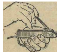
Рис. 46. Как вынуть спусковой рычаг
