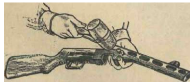
Рис. 51. Как вставить соединительную ось
