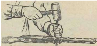
Рис. 37. Как выбить разрезную чеку
