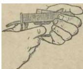
Рис. 44. Как установить переводчик на одиночный огонь
