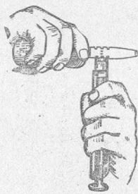
Рис. 51. Проверка выхода бойка ударника
