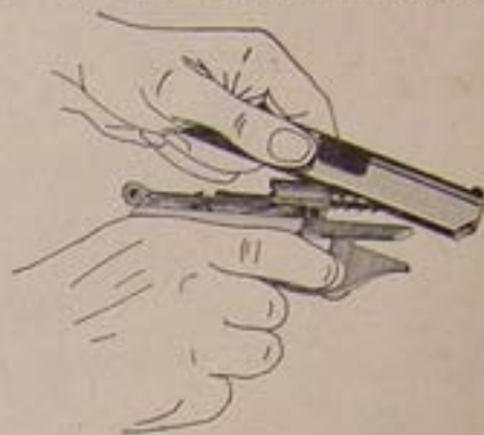
Рис. 25. Введение свободного конца возвратной пружины в канал затвора
