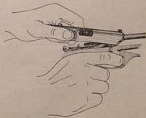
Рис. 26. Присоединение затвора к рамке
