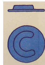
Рис. 19. Отличительный кружок с дугообразным выступом свистяще-светового сигнального патрона и его окраска:
