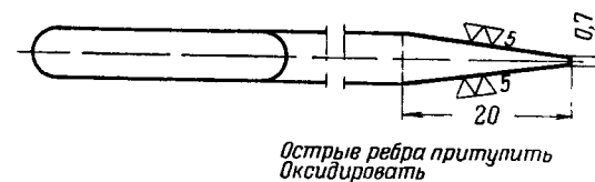
Рис. 77. Обработка лезвия отвертки
