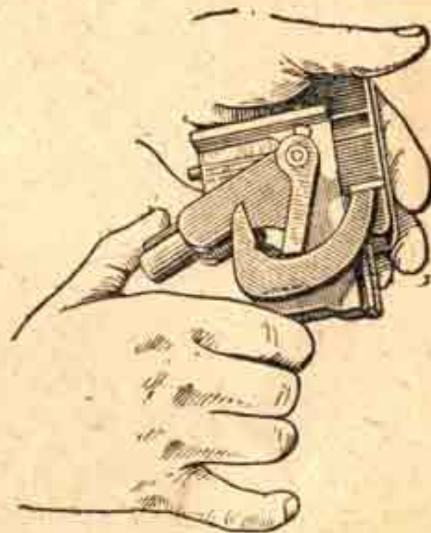
Рис. 52. Спуск ударника с боевого взвода.
