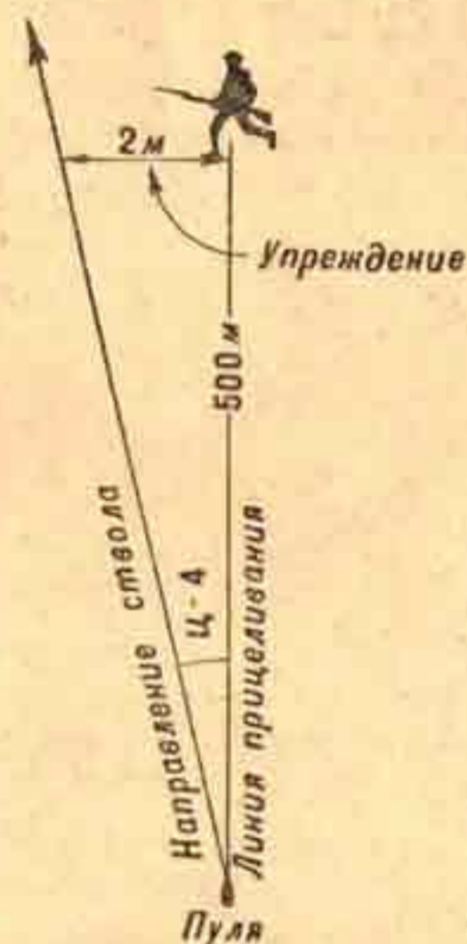
Рис. 116. Направление линии прицеливания и оси канала ствола в момент вылета пули.
