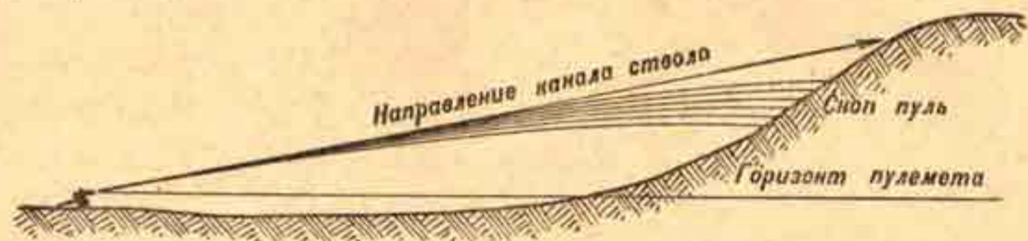
Рис. 119. Гребень возвышенности выше превышения пуль над горизонтом пулемета. Сноп пуль перехвачен гребнем.
