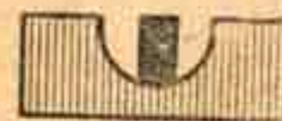
Рис. 14. Мушка видна посередине прорези прицела и наравне с ее краями.
