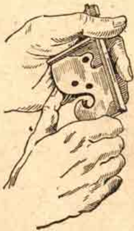
Рис. 63. Спуск ударника с боевого взвода.
