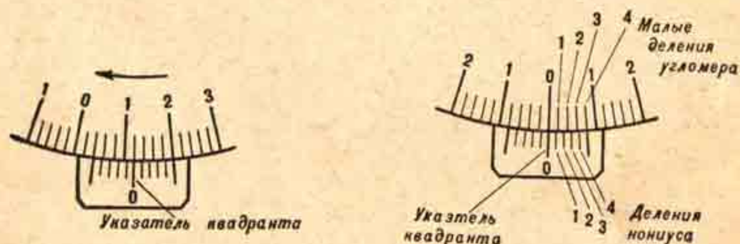
Рис. 105. Квадрант установлен на деление 1-20.
