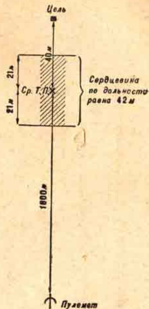
Рис. 76. Влияние ошибки в определении расстояния на поражение цели при стрельбе на большие дистанции.
