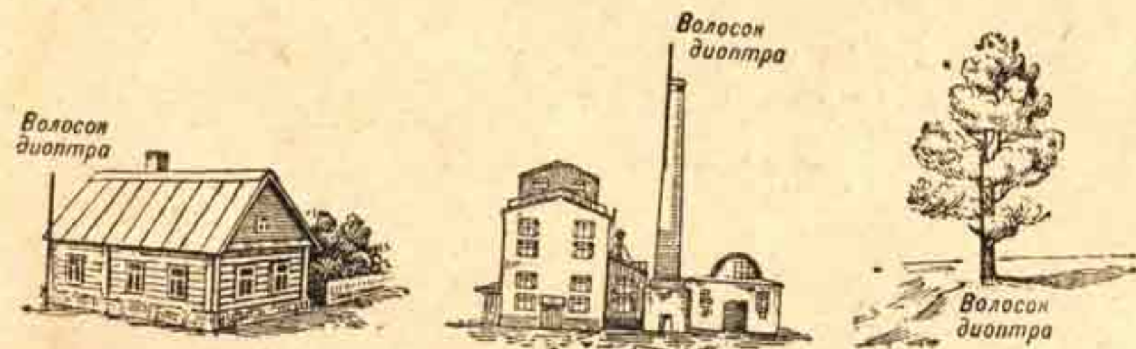
Рис. 99. Как должен быть направлен волосок предметного диоптра при наводке в различные местные предметы.
