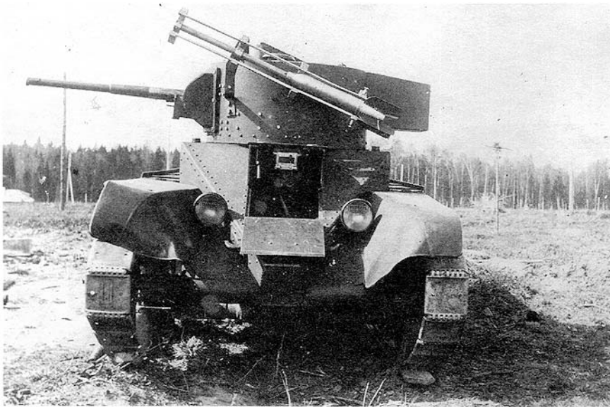
Танк БТ-5 с РС-132 во время заводских испытаний. Май 1935 года.
