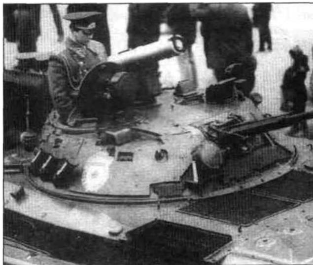
*Во время серийного производства БМП-2 неоднократно улучшалась. К началу 80-х для более надежной защиты от радиации на стенки башни была установлена дополнительная броня с добавками свинца. Сделать это подстегнули усилия американцев в 70-х годах по разработке более мощного тактического термоядерного оружия, более известного как нейтронная бомба. От дальнейшей разработки этой бомбы позже отказались.*
