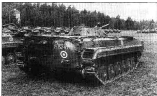
*БМП-1К представляет собой командную машину ротного уровня, сделанную на базе БМП-1. При внимательном осмотре кормовой части правого борта заметно отсутствие обычных амбразур и антенные гнезда для дополнительных радиоантенн. На снимке БМП-1К оборонительных сил Финляндии.*
