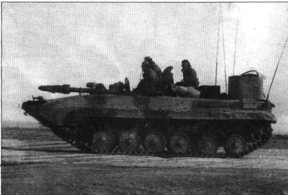
*БМП-1КШ является полковой командно-штабной модификацией семейства БМП, что видно по нескольким антеннам в корме. На машине спереди башни закреплена специальная телескопическая мачтовая антенна «Tall Mike» для обеспечения связи на больших расстояниях. БМП-1КШ на снимке, сделанном в Афганистане, имеет в левой части кормы большой бронированный бак для воды, что во время афганской войны на БМП было обычной практикой.*
