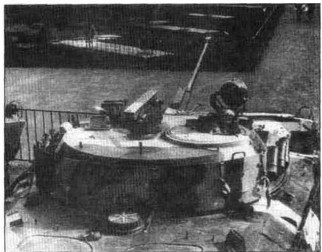
*На БМП-2Д часто встречалась дополнительная броневая плита позади башни, которая для пехотного отделения также служила еще одним местом хранения различных мелочей.*
