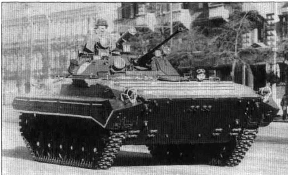
*На замену БМП-1 был в конце концов выбран объект 675 с новой 30-мм автоматической пушкой Шипунова 2А42 в новой полнопрофильной башне на двух человек на корпусе БМП стандартной длины. Эта машина при принятии на вооружение в 1977 году получила обозначение БМП-2. Крылья машины были расширены для установки плавучего материала, поскольку дополнительный вес башни отразился на плавучести машины при пересечении водных преград.*
