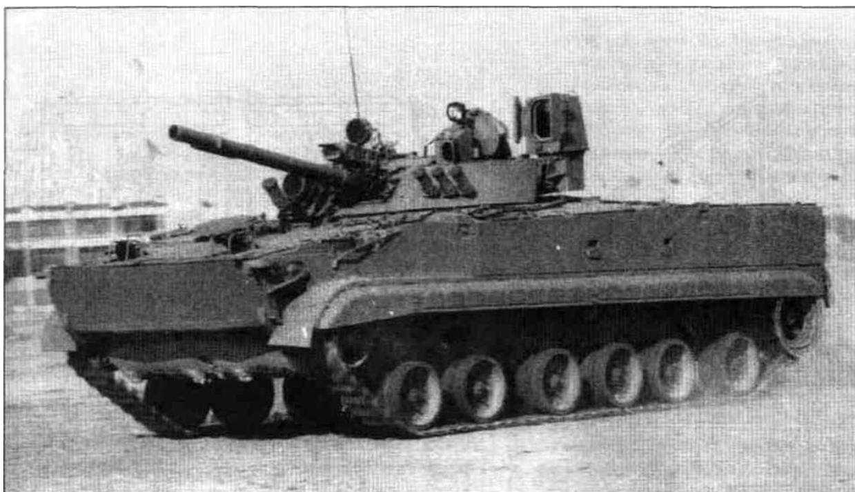
*Первым экспортным клиентом БМП-3 стал Абу Даби, получивший 82 БМП-3 в 1992 году. Машины были оборудованы внешним тепловизионным прицелом «Намю», который производится французской фирмой SAT. Абу Даби выбрал этот прицел поскольку он используется на основных боевых танках «Леклерк», которые эмират уже получает. Этот прицел нельзя установить на обычном месте внутри из-за скученного расположения приборов управления огнем.*
