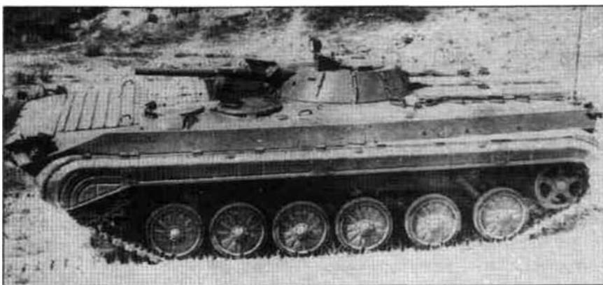
*Первоначальная серийная БМП образца 1966 года отличалась от обычной БМП-1 во многих деталях: она имела более короткую носовую часть, на ней не было панели доступа к системе химических фильтров слева от башни, и у нее отличалась компоновка люков на крыше в кормовой части корпуса. Эта модификация производилась в небольших количествах, в основном для полевых испытаний.*
