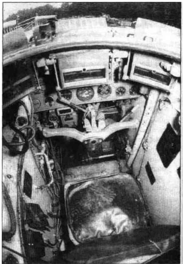
*Одним из появившихся на БМП нововведений была простая рулевая колонка, благодаря которой управление стало намного более простым, чем с рычагами тракторного типа. Заметьте, что ручка переключения положения рычагов расположена на рулевой колонке.*
