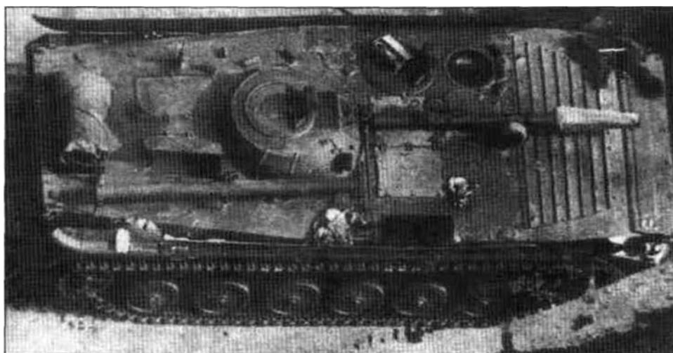
*Вид сверху БМП-1КШ показывает базовую схему: башня похожа на обычную башню БМП-1, но в ней нет вооружения; перед башней расположена антенна «Hawk Eye». Большая труба справа башни - контейнер для дополнительных антенн. БМП-1КШ обычно несут в корме дополнительные генераторы и прочее оборудование.*
