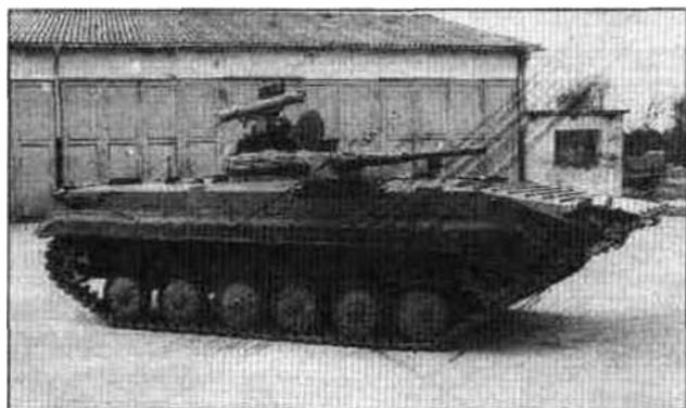
*БМП-1П вместо ракеты 9М14М «Малютка» оснащена ракетами 9М111 «Фагот» или 9М113 «Конкурс», запускаемыми с направляющей 9П135 на крыше башни. Это означает, что в момент запуска стрелок открыт для огня противника.*
