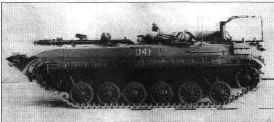
*Вид сбоку болгарской БМП-1КШМ показывает типичную компоновку модели 9С743 с большим генератором в левой части корпуса, который использовался для питания множества радиопередатчиков, бывших у этого варианта полкового командного пункта.*
