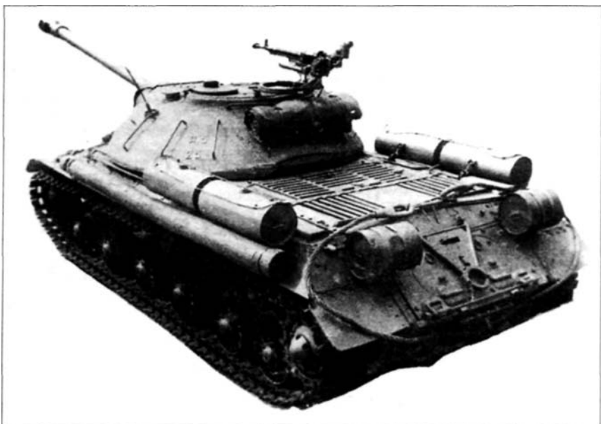
ИС-3. Ввод антенны расположен на наклонной стенке башни - характерная деталь машин первых выпусков (Фото из коллекции Г. Петрова)
