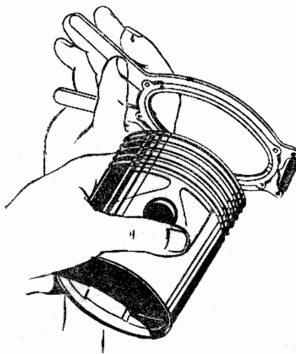
Фиг. 57. Приспособление для надевания поршневых колец на поршень.
