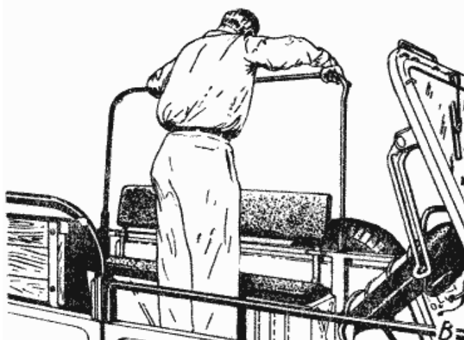
Фиг. 133. Укладка полога тента в кузове ГАЗ-69: А - укладка сложенного полога под сиденьем водителя, Б - крепление чехла с продольными связями к боковому сиденью, В - перестановка дуг каркаса тента вдоль бортов кузова.
