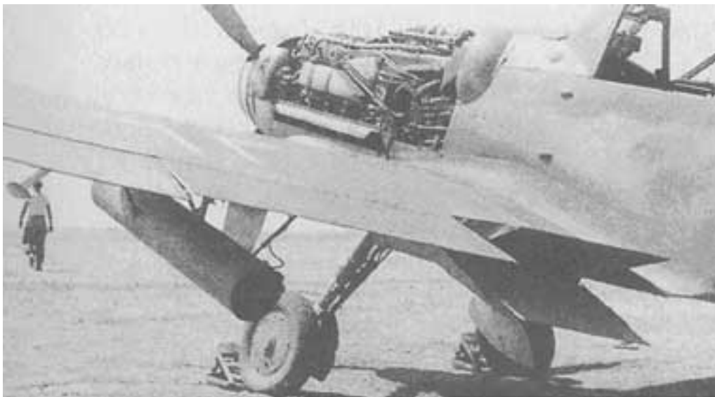
Bf 109G-6 с установкой 210-мм ракет под крылом.
