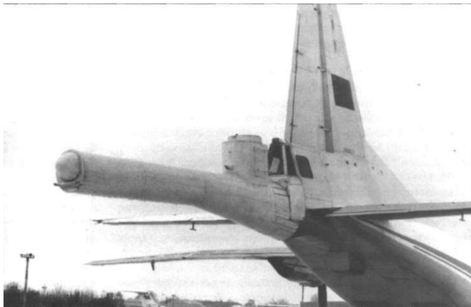
Для размещения испытуемого оборудования летающие лаборатории часто приходилось «украшать» могучими надстройками (фото А.В. Доценко) / Frequently, different flying labs possessed such huge superstructures to accommodate equipment being tested (A.V. Dotsenko)
