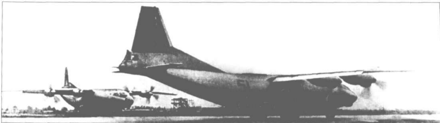
Крыло Ан-12 имело мощную механизацию - щелевые закрылки. На снимке - закрылки во взлетном положении (архив СТ. Мороза) / An-12 wing features efficient high lift devices. The aircraft is shown TE flaps at takeoff position (S.G.Moroz archives)
