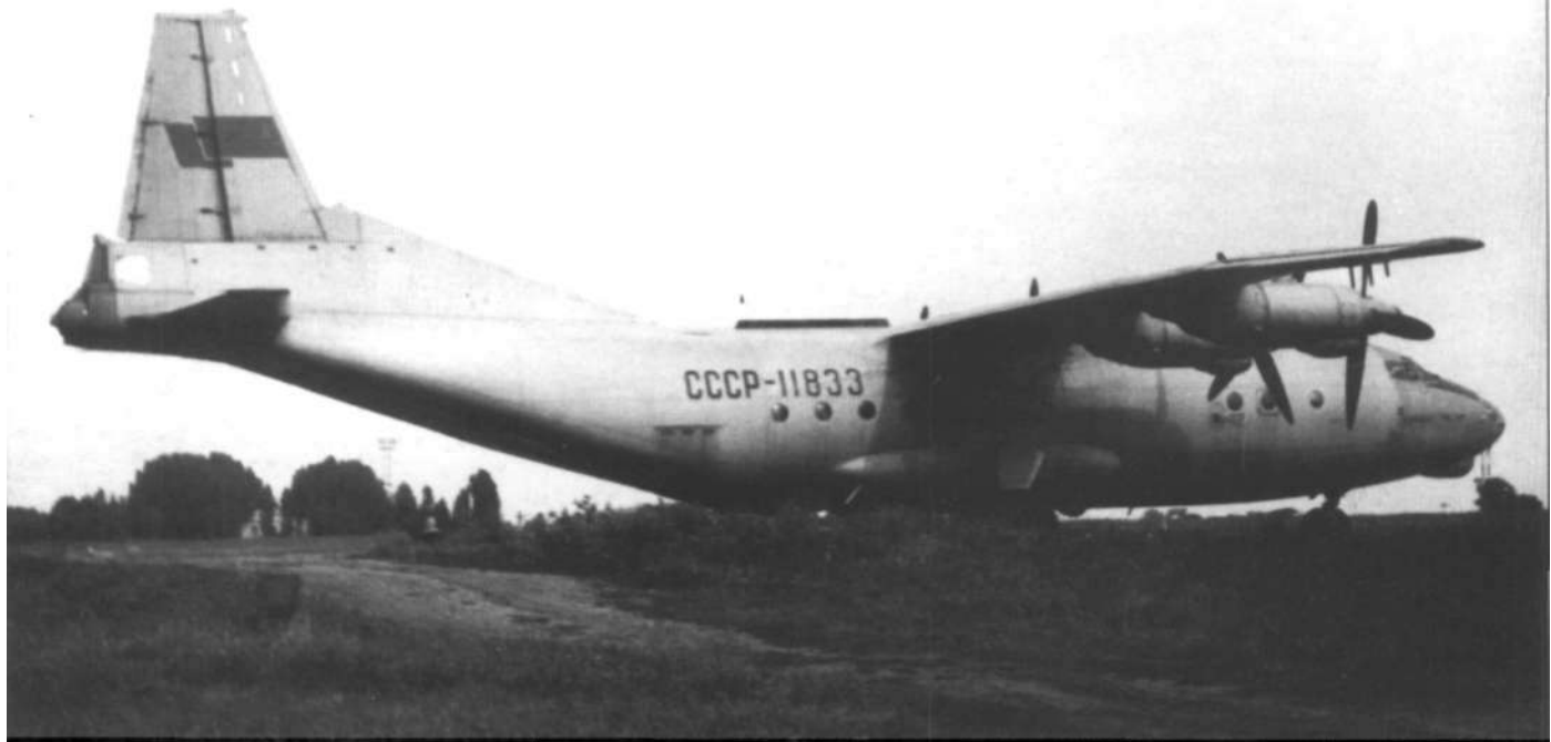
Выцветшая окраска, потеки на бортах и фанера в окнах стрелковой точки. В таком неприглядном состоянии оказались многие вполне работоспособные Ан-12 с «победой перестройки» (фото А.В. Доценко) / Faded paint, dirty fuselage, disabled tail turret. This condition featured many An-12s after «perestroika» (political reform) victory (A.V. Dotsenko)
