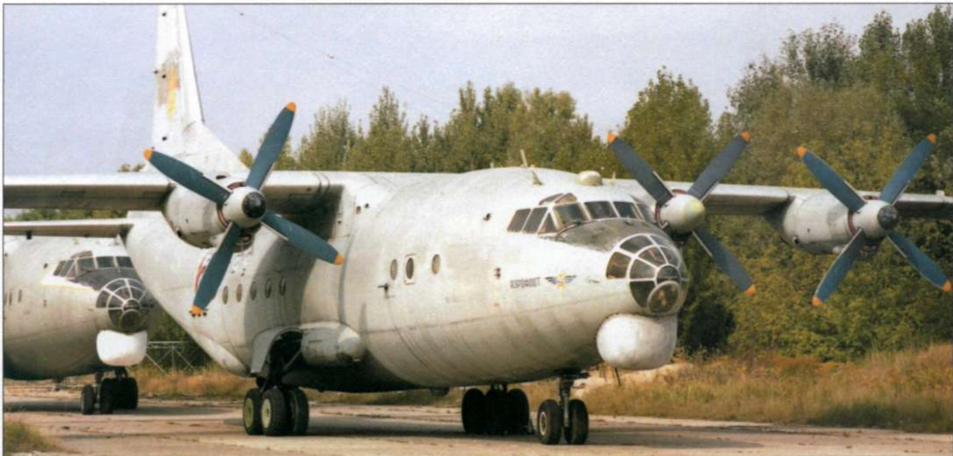
Ан-12 с радиолокатором «Инициатива» / The An-12 equipped with «Initiativa» radar
