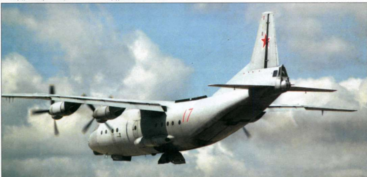
Момент закрытия больших створок носовой и основных опор шасси / A moment of large MLG and NLG wheel well doors closing
