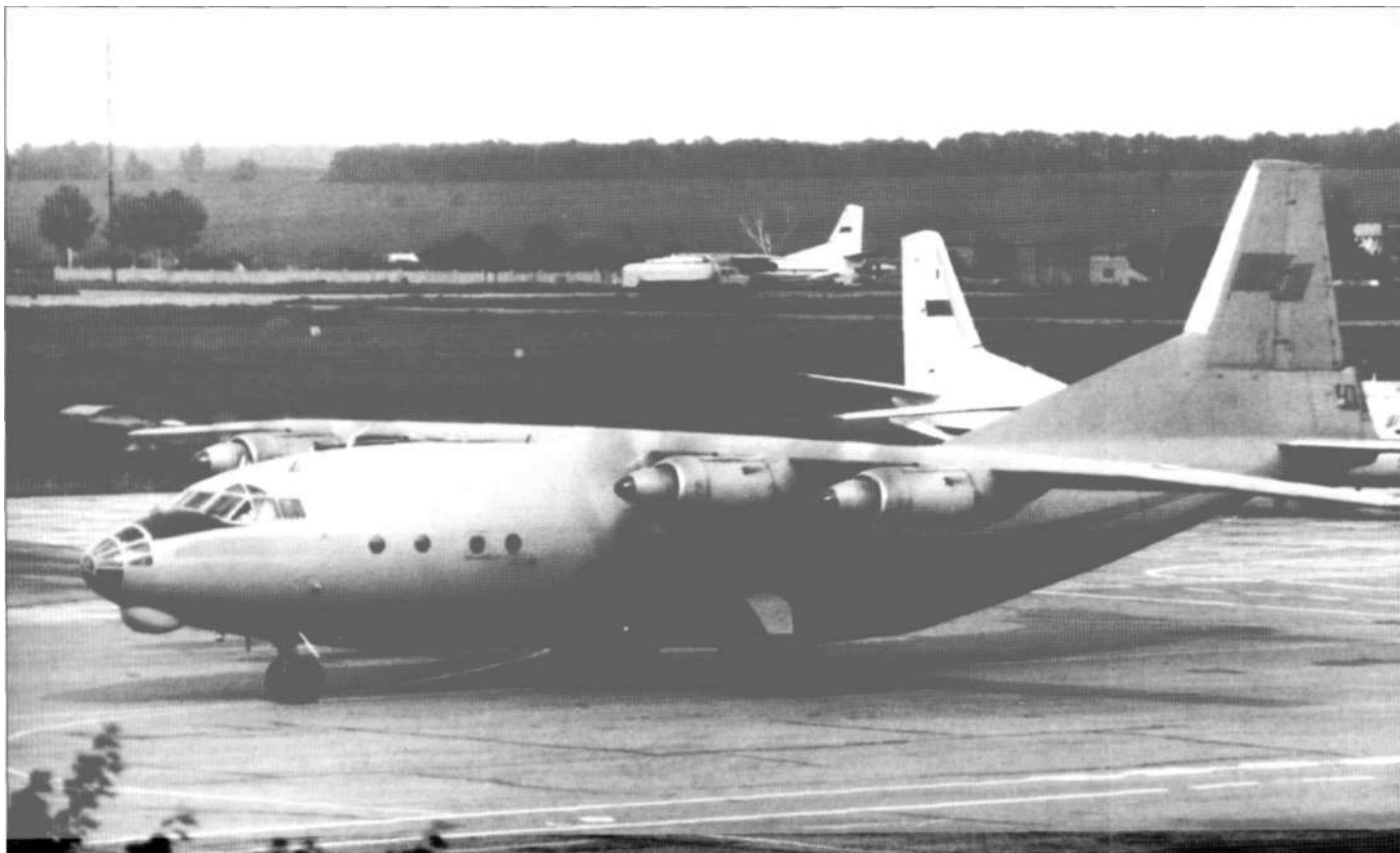
Ан-12 раннего выпуска, доработанный установкой радиосистемы дальней навигации. Антенна РСДН устанавливалась в передней кромке кия (фото А.В. Доценко) / Early An-12 upgraded with long range navigation system. The equipment aerial was placed at vertical fin leading edge (A.V. Dotsenko)
