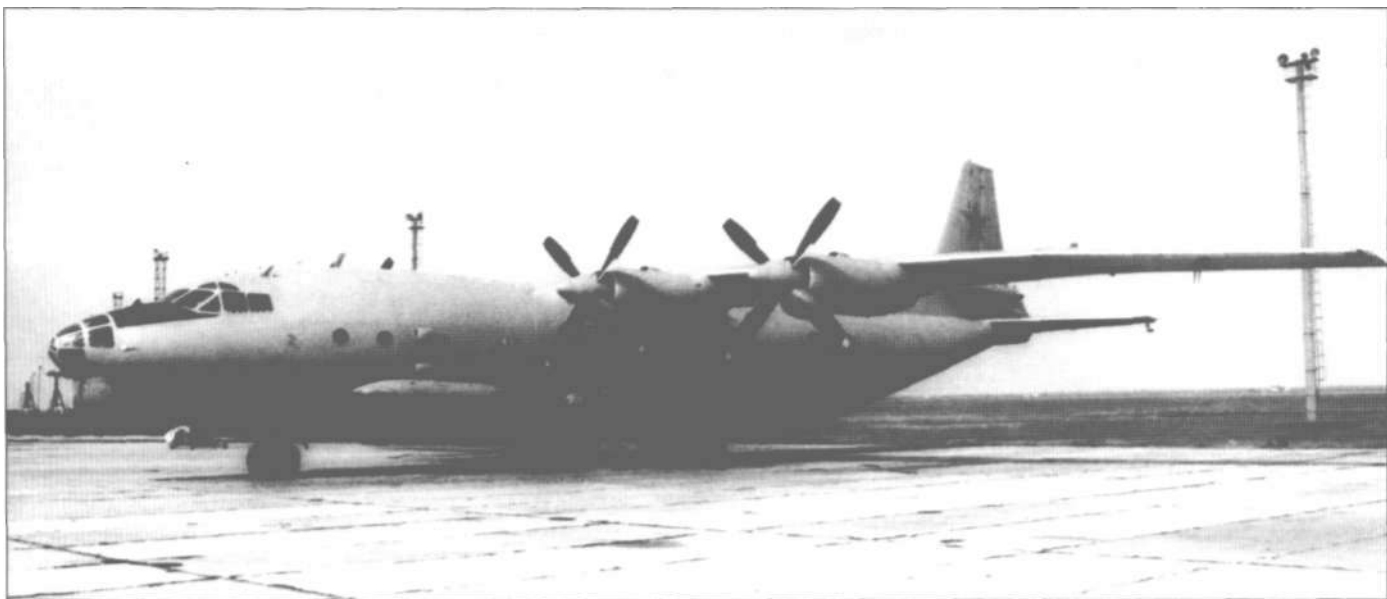
Самолет РЭП Ан-12БК-ППС выделялся мощными контейнерами спецсистем на фюзеляже и оперении (архив редакции) / Electronic warfare (EW) An-12BK-PPS featured huge special system containers beneath the fuselage and at the tail unit (Editorial archives)
