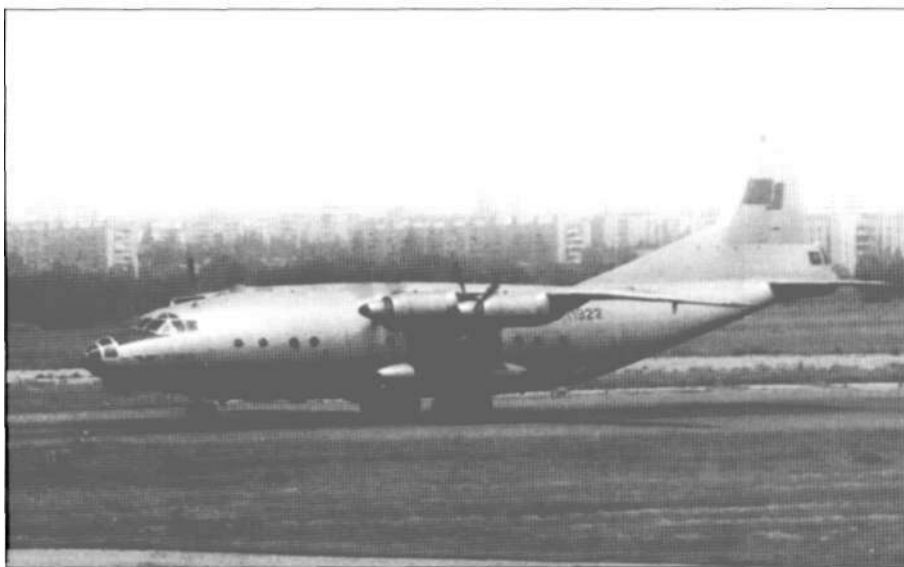
Самолет Ан-12 заруливает на стоянку после посадки. Внешние двигатели выключены, а внутренние - на малом газу (фото А.В. Доценко) / Having landed the An-12 taxis to a stand. Outer engines are cut off, but inner ones operate at idle (A.V. Dotsenko)
