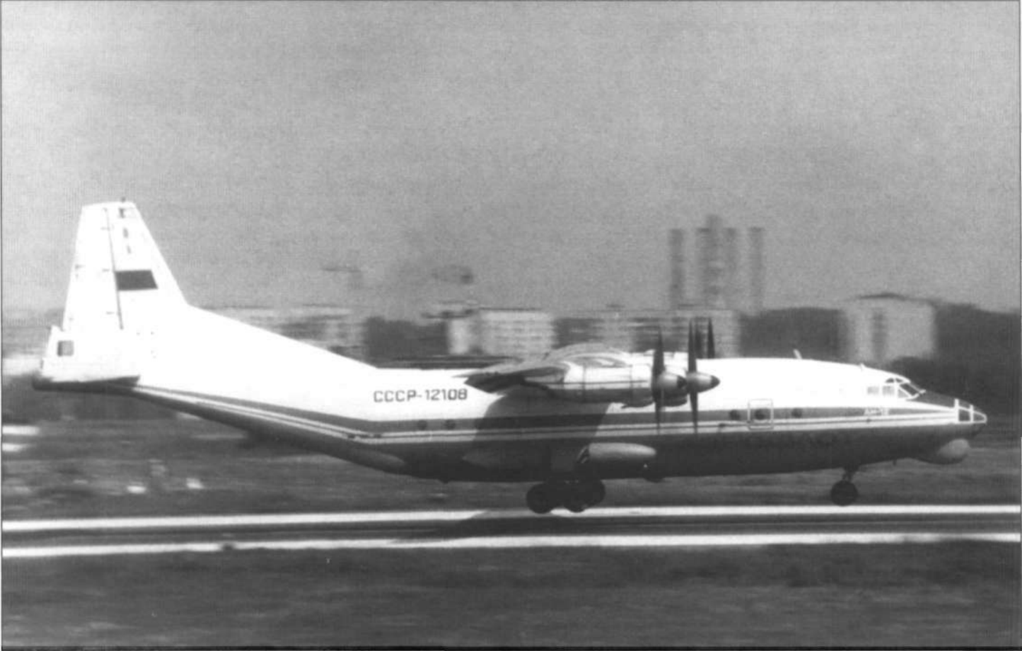
Самолеты с пилотажно-навигационным комплексом «Полет» обычно передавались в гражданскую авиацию из ВВС. На снимке хорошо виден мощный обтекатель РЛС «Инициатива» (фото А.В. Доценко) / Possessing «Polet» flight management equipment aircraft usually were delivered from air force to civil aviation. Note huge «Initsiativa» radar dome (A.V. Dotsenko)
