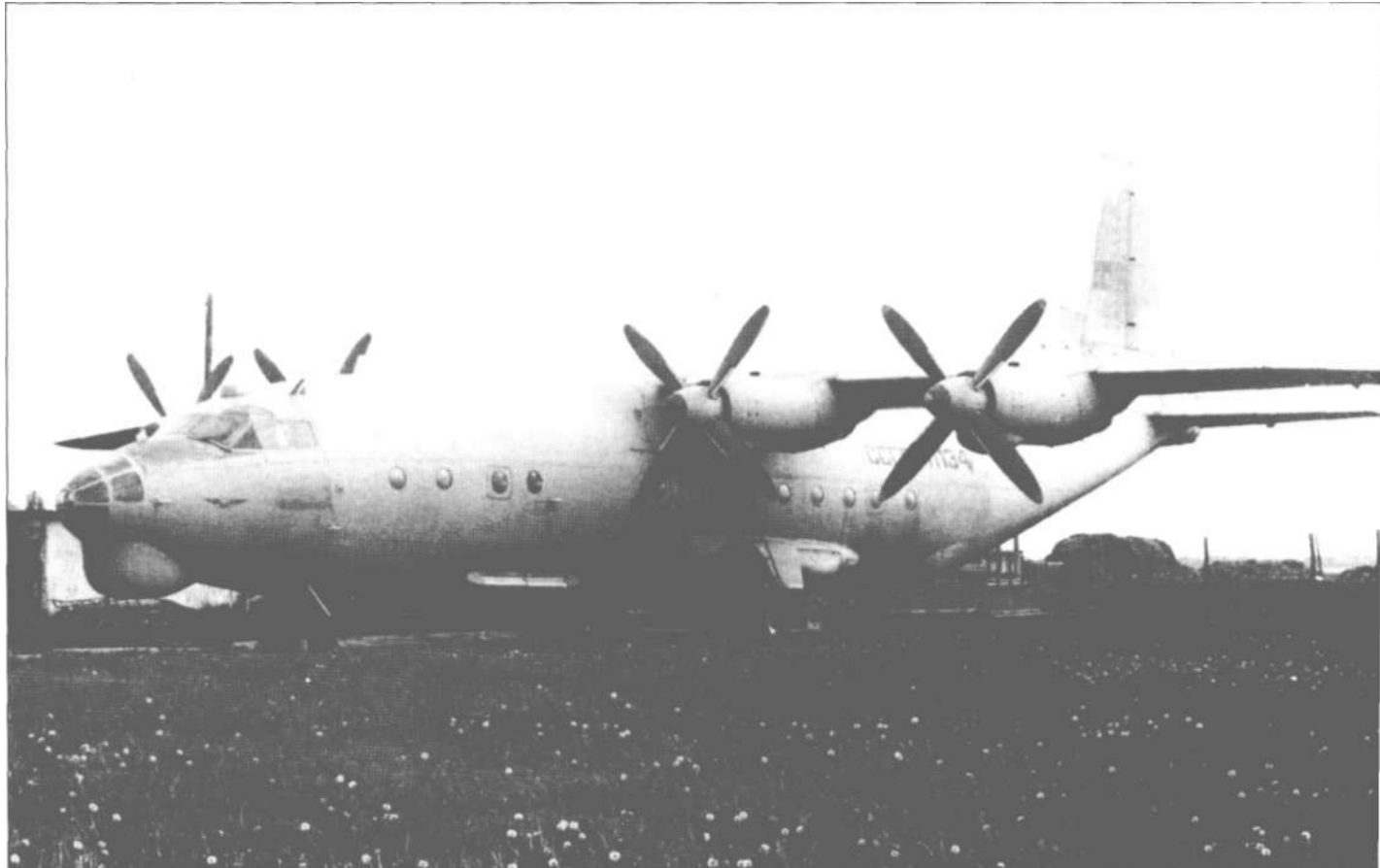
Самолет Ан-12БК с увеличенным обтекателем под РЛС «Инициатива». Кроме того, установлены станция группового самолетовождения (обтекатель над кабиной) и кассеты тепловых ловушек (архив редакции) / This An-12BK features enlarged «Initiativa» radar dome. Furthermore, the aircraft was fitted with formation flight navigation equipment (note a fairing at bottom fuselage) and flare dispensers (Editorial archives)
