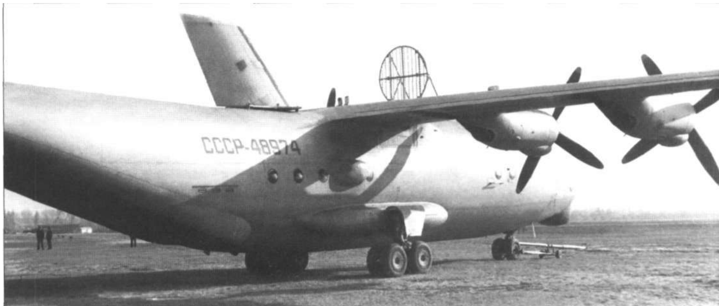
«Танкер» — летающая лаборатория для испытаний противообледенительных систем (архив редакции) / «Tanker» — the anti-icing systems flying lab (Editorial archives)
