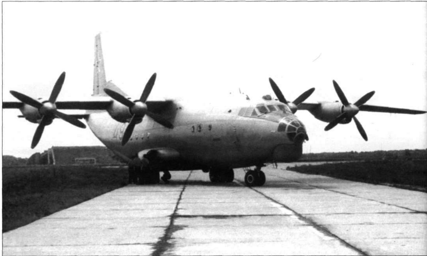
Ан-12 с пилотажно-навигационной системой «Полет», РЛС «Инициатива» и станцией группового самолетовождения (фото А. Никифорова) / The An-12 having «Polet» flight management system, «Initsiativa» radar and formation flight navigation equipment (A. Nikiforov)
