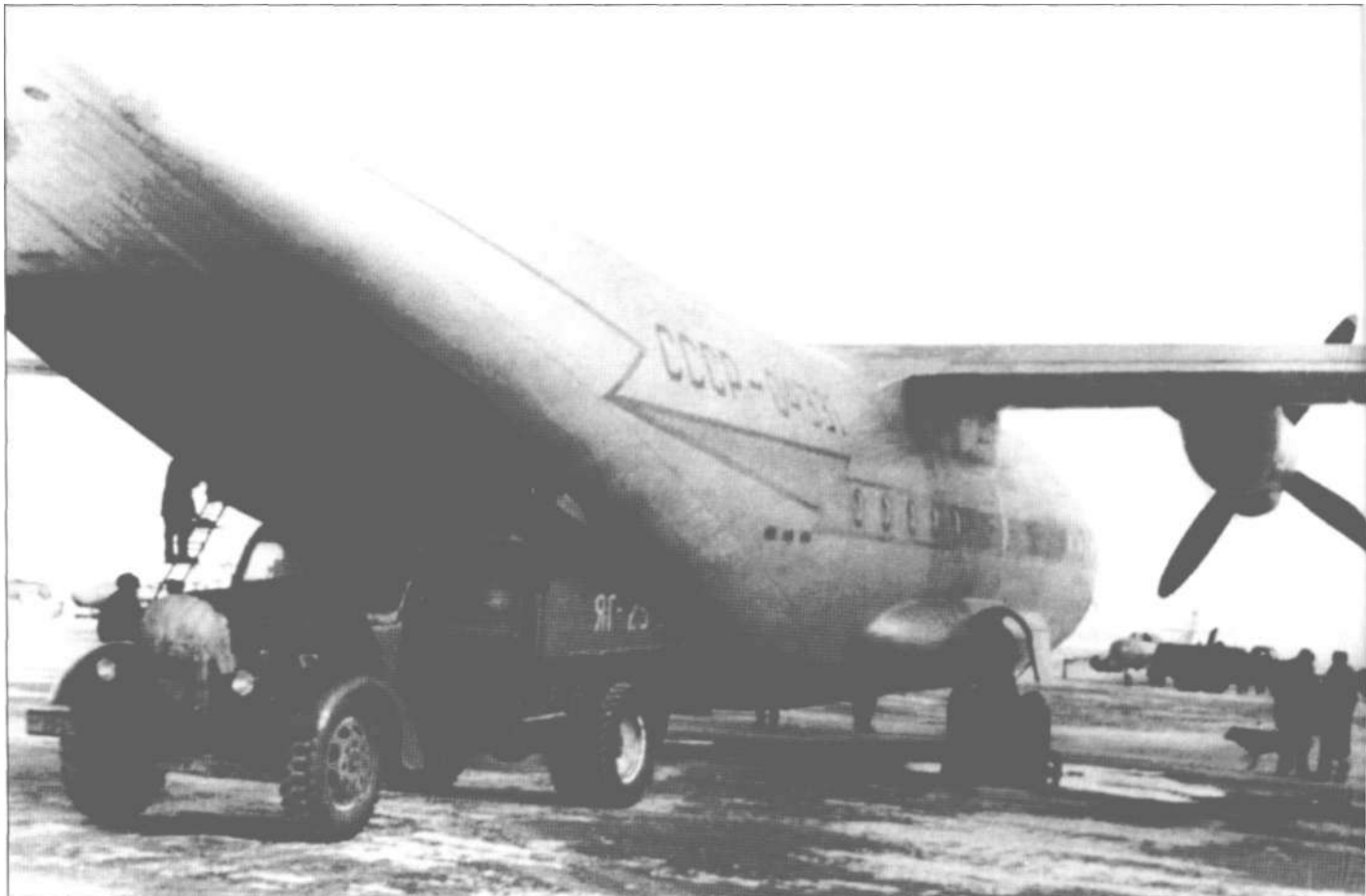
Небольшой клиренс самолета Ан-12 был одновременно и преимуществом, и недостатком. Это позволило упростить погрузку, но привело к повышенному износу днища фюзеляжа (Архив редакции) / Low runway clearance was both advantage and shortage. This facilitated cargo loading but yielded bottom fuselage wearout (Editorial archives)
