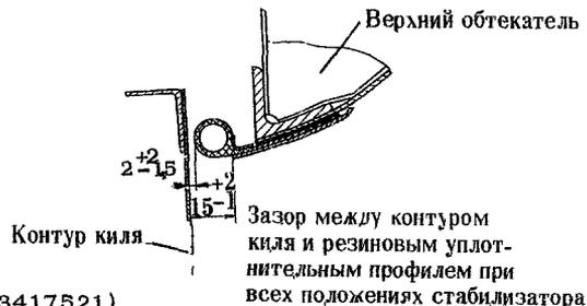
ПРОВЕРКА ЗАЗОРОВ И ВПИСЫВАЕМОСТИ
